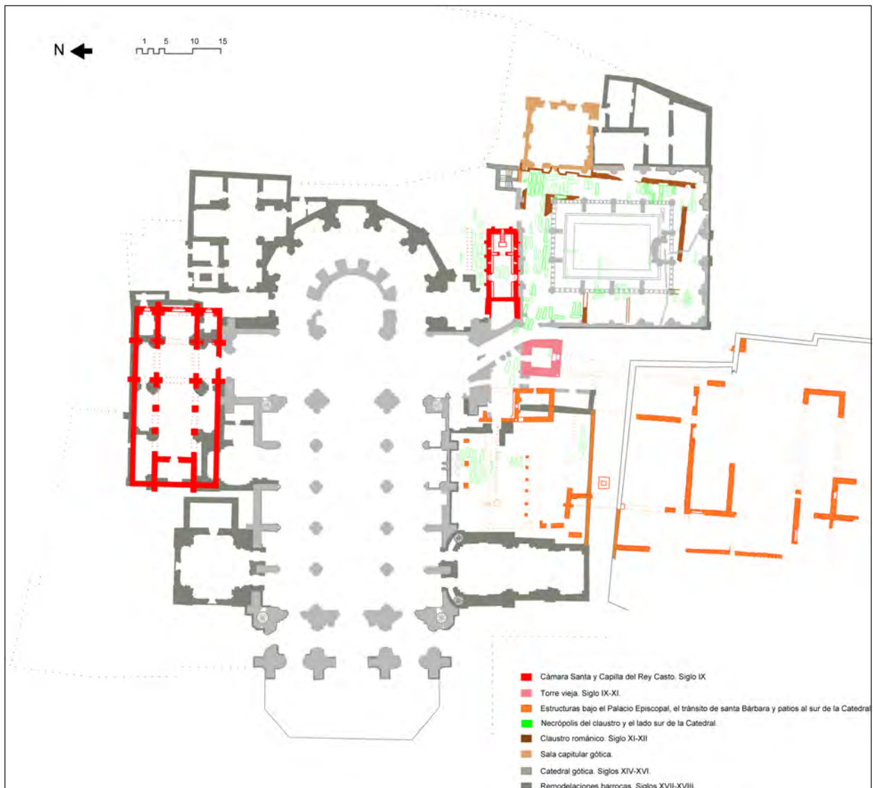
Fig. 2. Conjunto catedralicio de Oviedo. Planta de fases constructivas. Dibujo: Montserrat Valls Mora.
